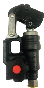
1FK6487 Pompe manuelle simple effet en ligne sans réservoir. Volume par course : 20 cm 3 . - Pression max. : 150 bar. Tige : Ø20 mm.
