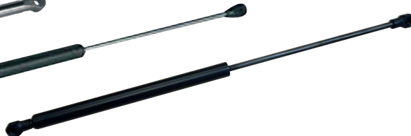
1TR002621 L. hors filetage : 485 mm. Tige : Ø 8 mm x 230 mm. Tube : Ø 20 mm. Force : 400 N.
