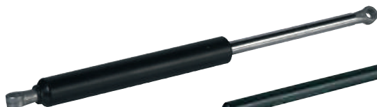
1TR002620 L. hors filetage : 400 mm. Tige : Ø 14 mm x 150 mm. Tube : Ø 28 mm. Force : 1000 N.
